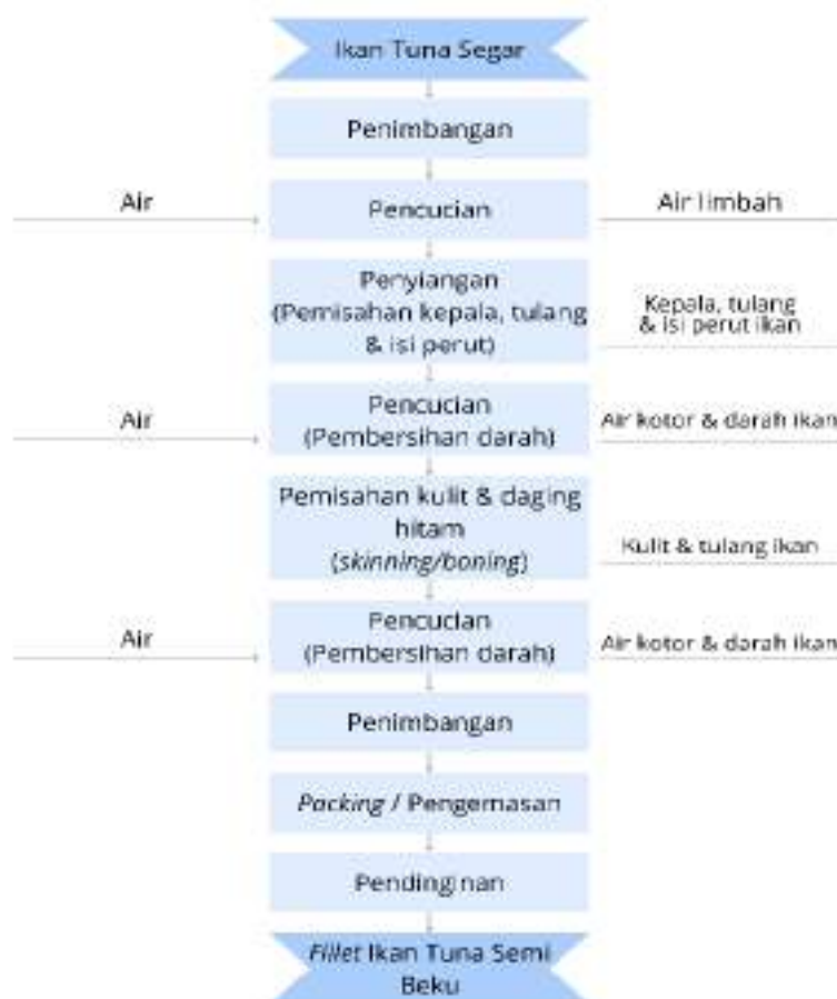
Gambar 4.27 Alur Produksi Ikan Fillet Beku
