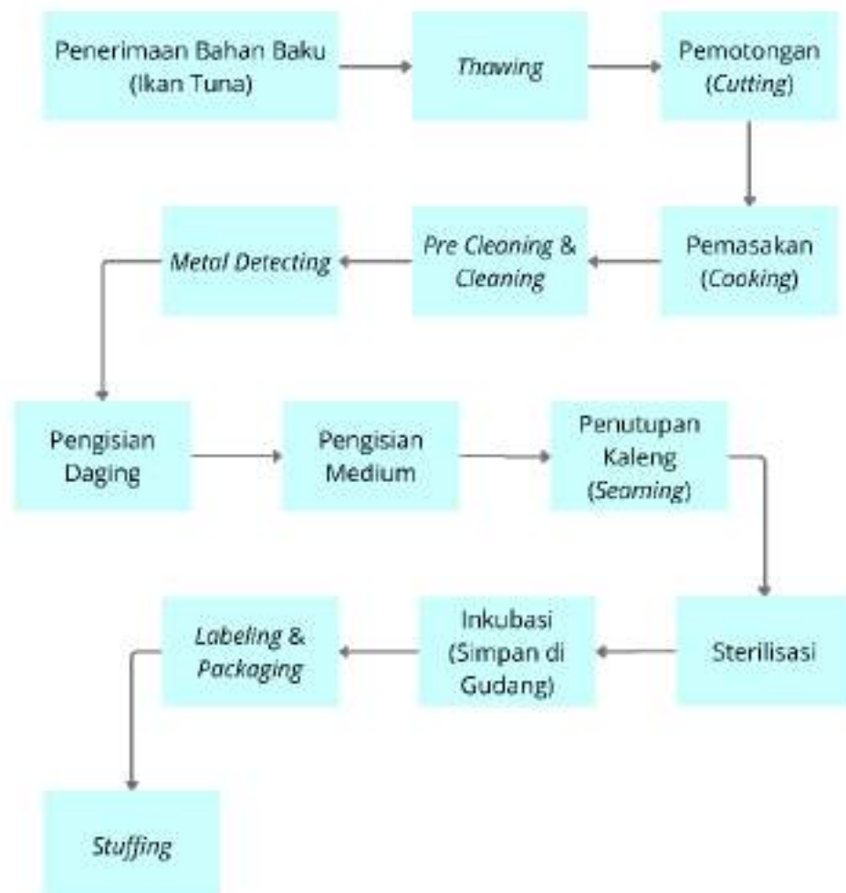
Gambar 4.28 Alur Produksi Pengalengan Ikan Tuna
